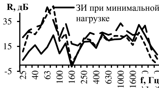
Рис. 11 – Значения звукоизоляции при минимальном, максимальном и целевом уровнях внешнего акустического нагружения
