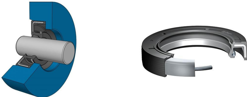
Рис. 2 – Уплотнения импеллерные и манжетного типа
