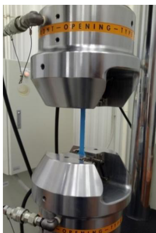
Рис. 2 – Схема испытаний на прочность при растяжении образцов из полиэтилентерефталатгликоля (PETG) на разрывной испытательной машине SHIMADZU SERVO PULSER
