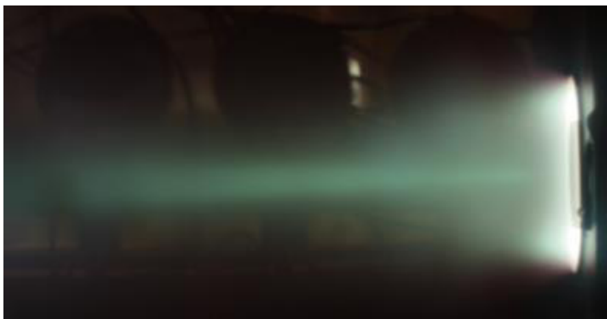
Рис. 10 – Вид СПД-70М работающего на ксеноне
