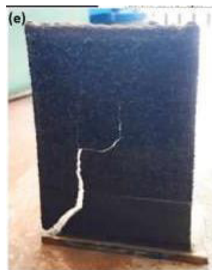
Рис. 11 – Разрушение образца под действием внутренних разрушений [16]
